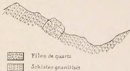
Fig. n° 36. Profil à travers le filon de Sakalina.
