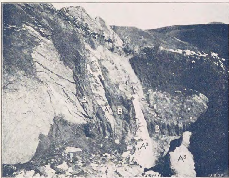
Phot. n° 20. — Vue du front de taille de la partie N.-O. de la tranchée n° 4. A¹, A², A³ sont les veines lenticulaires de pegmatite; B est le cipolin.
