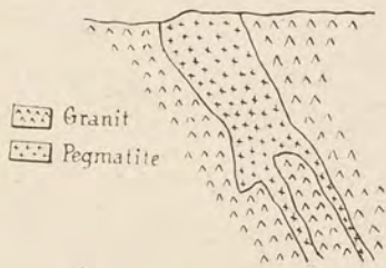
Fig. n° 22. Profil montrant la disposition du filon de Tétéhina.
